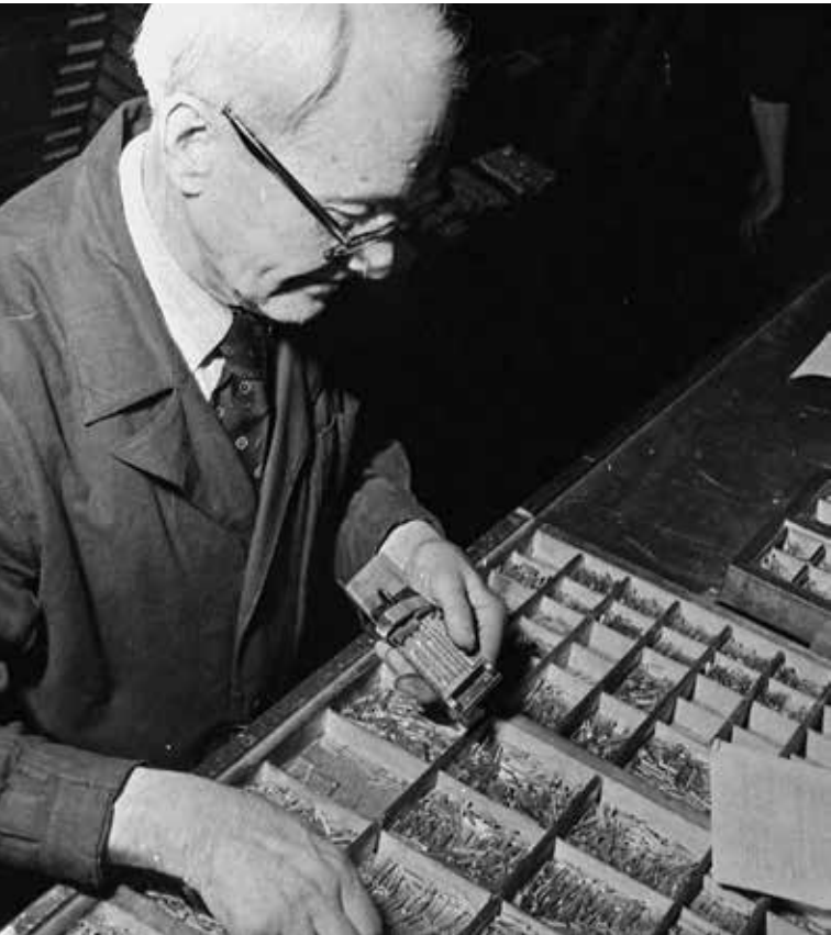
Käsinlatoja Kaarlo Humaloja työssään vuonna 1951. Käsinlatojan tärkein työkalu oli latomahaka, johon kirjaimet noukittiin. Kuva: LK / Päivälehdien arkisto
