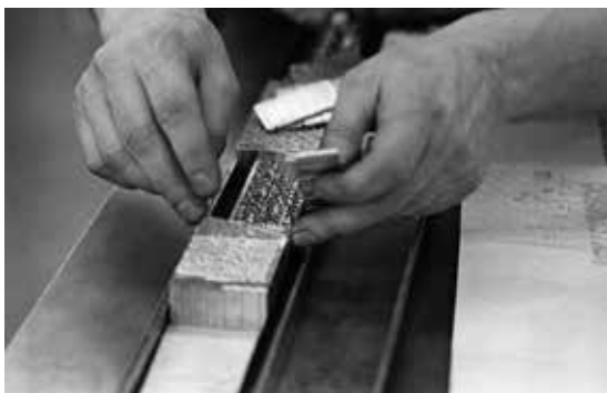
Metallipalstan korjaus käynnissä. Kuva: LK / Päivälehdien arkisto
