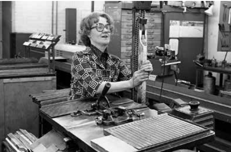
Ludlow-latomakone valoi ladotut rivit lyijystä, antimonia ja tinasta koostuneesta seoksesta. Kuvassa ”lyijykankea” asetetaan valinkoneeseen. Kuva: LK / Päivälehdien arkisto
